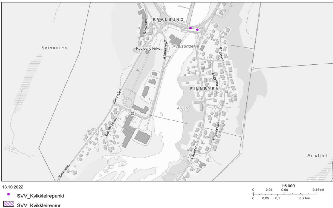
Figur 5 Områder der det er påvist kvikkleire ved tidligere undersøkelser markert med lilla punkter
