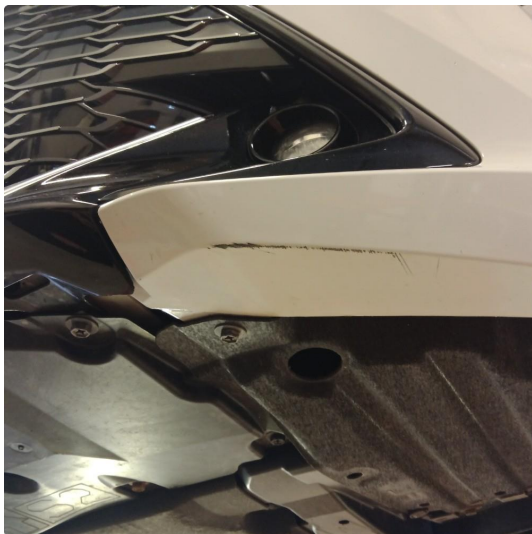
1.7 Riper og diverse steinsprut. Lakkere
