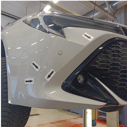
1.7 Riper og diverse steinsprut. Lakkere
