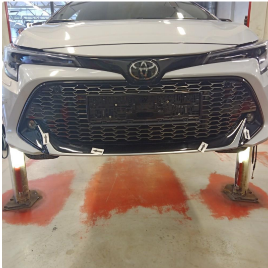
1.8 Deksel på frontfanger. Diverse riper og steinsprut
