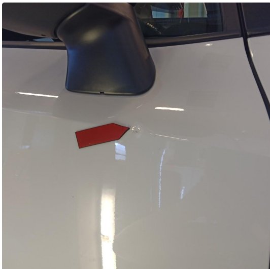
1.2 Liten bulk med lakkskade
