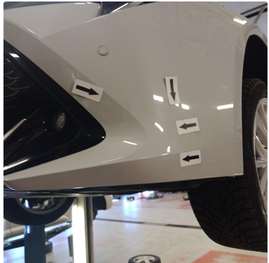
1.7 Riper og diverse steinsprut. Lakkere
