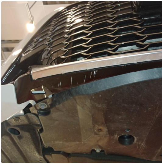
1.8 Deksel på frontfanger. Diverse riper og steinsprut
