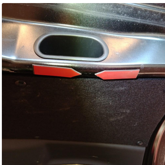
1.4 Lakkskader og bulk
