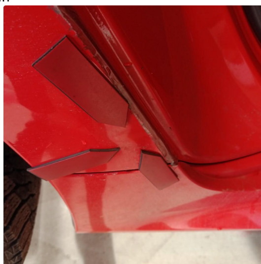
1.5 Bulker og lakkskader langs med beskyttelses teipen
