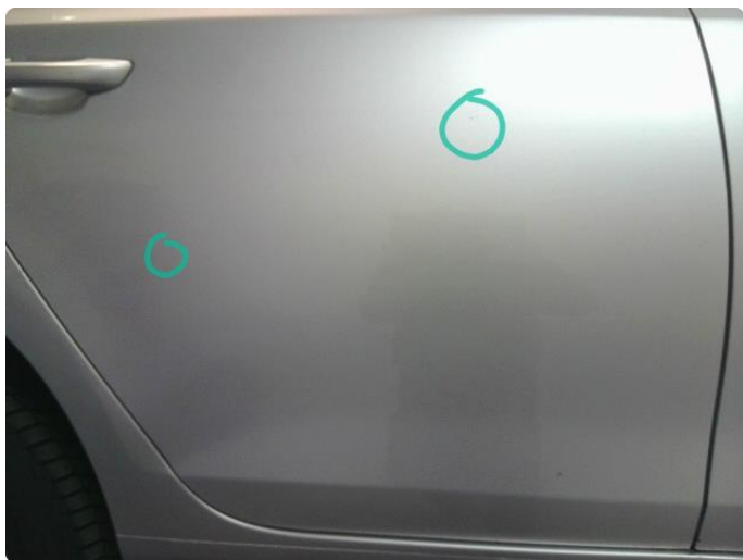
1.5 Steinsprut med rust
