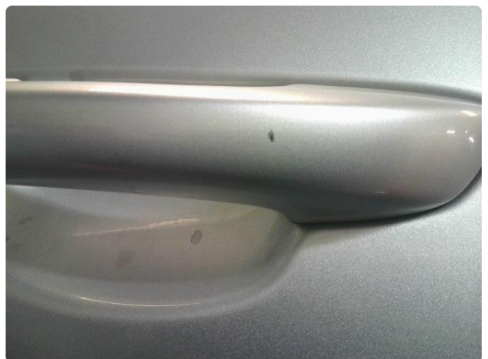
1.5 Steinsprut med rust
