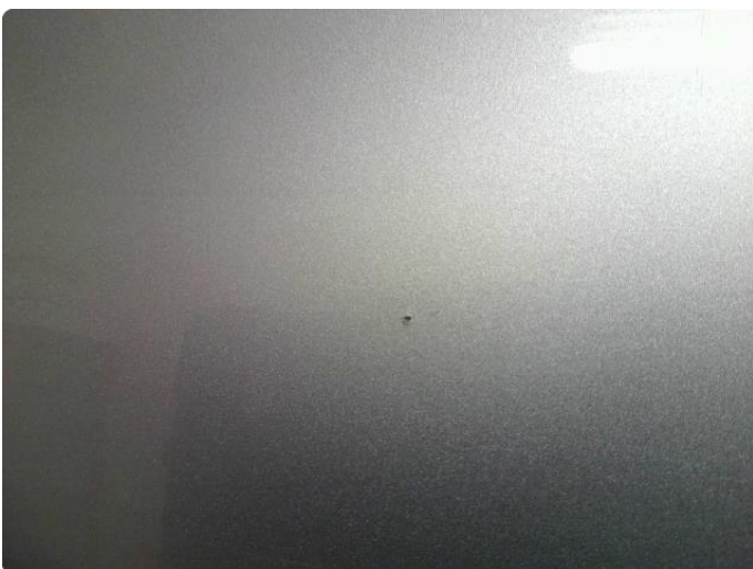
1.5 Steinsprut med rust
