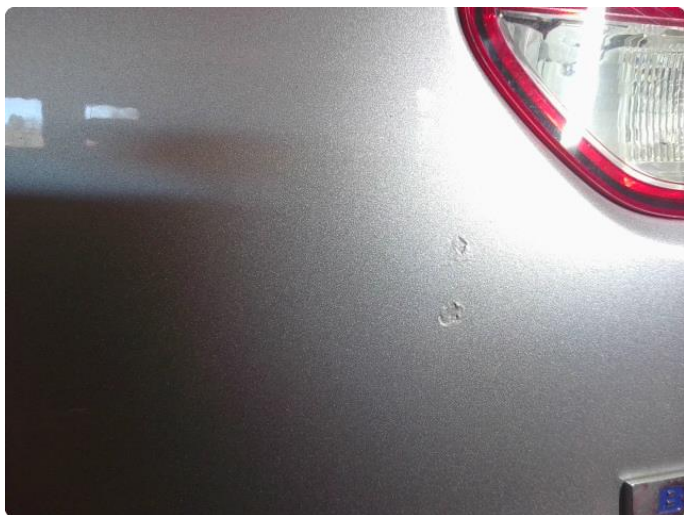
1.8 Steinsprut med rust
