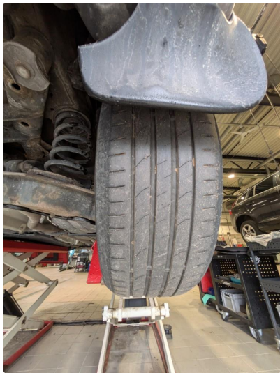
1.3 Skjev slitasje på sommerdekk. Blir byttet.
