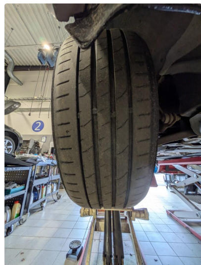
1.3 Skjev slitasje på sommerdekk. Blir byttet.
