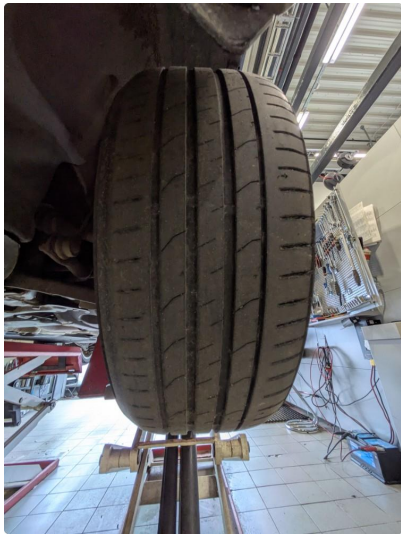
1.3 Skjev slitasje på sommerdekk. Blir byttet.
