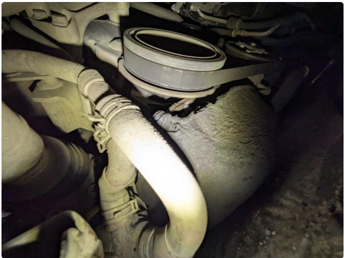
2.1 Dynamoreim slitt. Blir skiftet.
