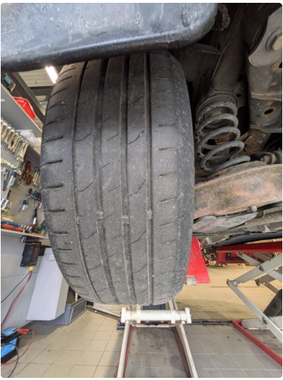
1.3 Skjev slitasje på sommerdekk. Blir byttet.
