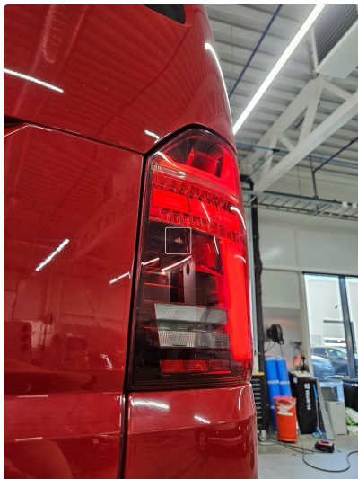
2.1 Lite hakk/sår på h.side, ikke dugg/fukt i lampe, anmerket
