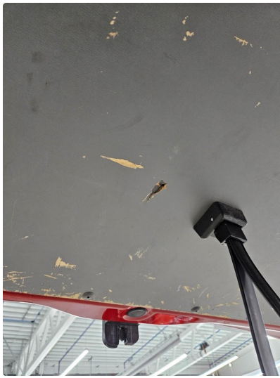
3.1 Bruksmerker på innv. bekledning, bakluke
