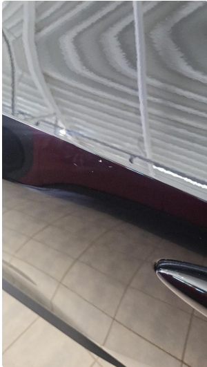
1.2 Ripe ned til grunning
