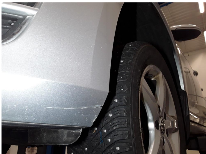
1.3 Noe oppriperet lakk nede på støtfanger foran. Normal bruksslitasje
