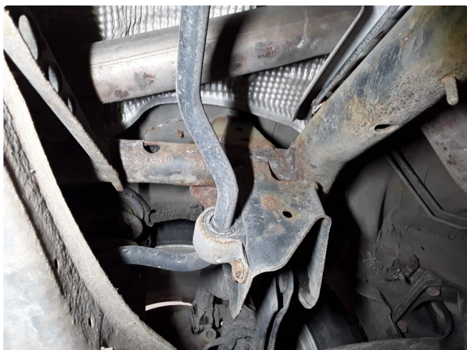
1.1 Noe rustdannelse på understell. Ingen rusthull eller rust av betydning. Normal bruksslitasje
