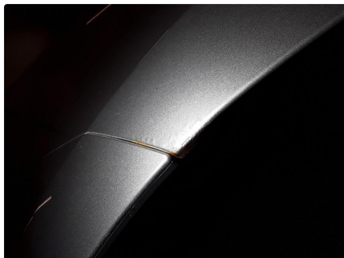
1.2 Noe påbegynt rustblemmer på venstre forskjerm, begge bakskjerner og på hjulbuer. Normalt ihht alder/km.stand.
