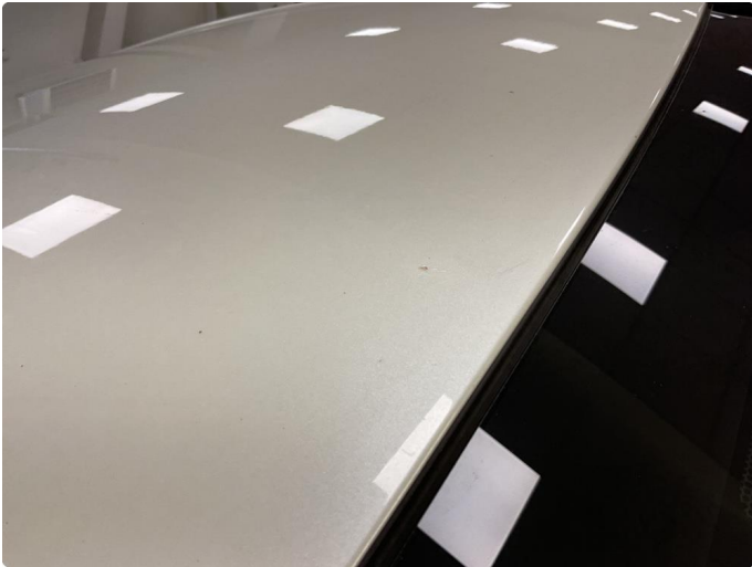
1.1 Steinsprut på taket
