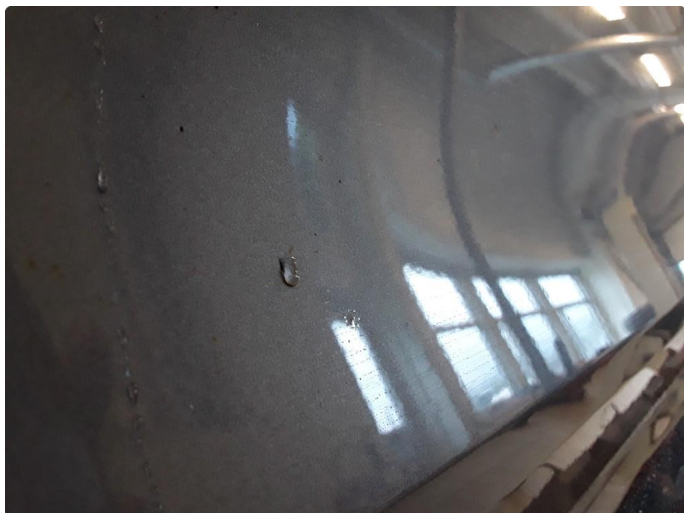
1.2 Liten steinsprut med korrosjon venstre foran.
