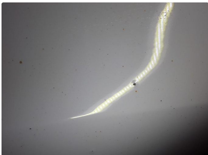
1.2 Steinsprut med rust
