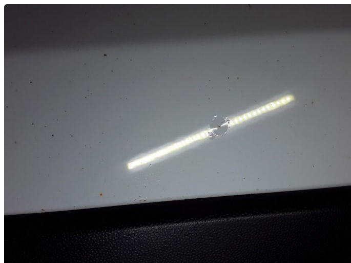
1.2 Steinsprut med rust
