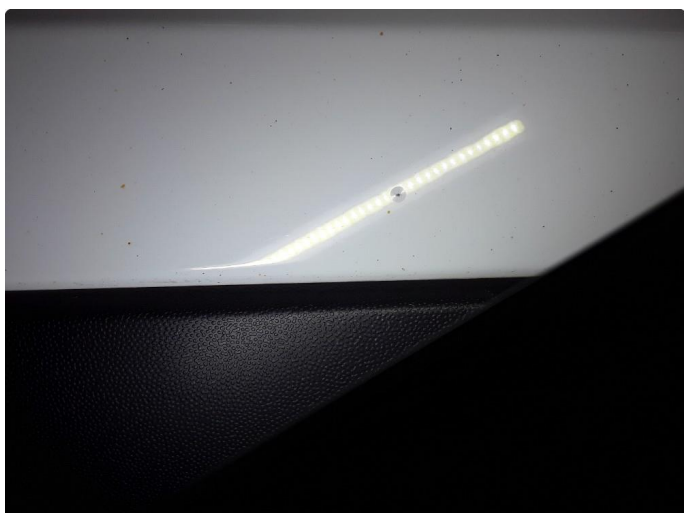
1.3 Steinsprut med rust
