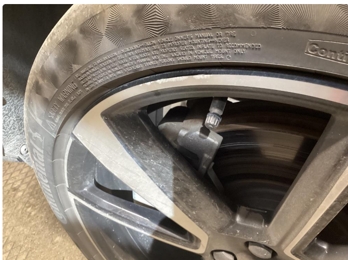
1.1 Kantkjørt felg, normal bruks slitasje
