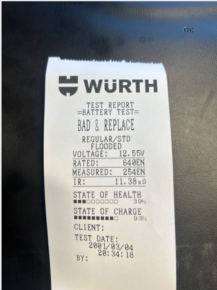
5.2 Batteritest «bad and replace»
