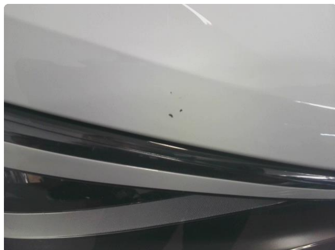
1.1 Ripe(r) ned til grunning
