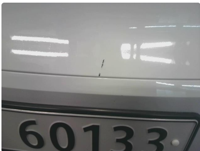
1.1 Ripe(r) ned til grunning
