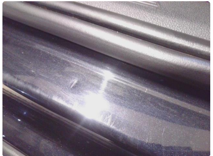
1.2 Bulk(er) med lakkskade
