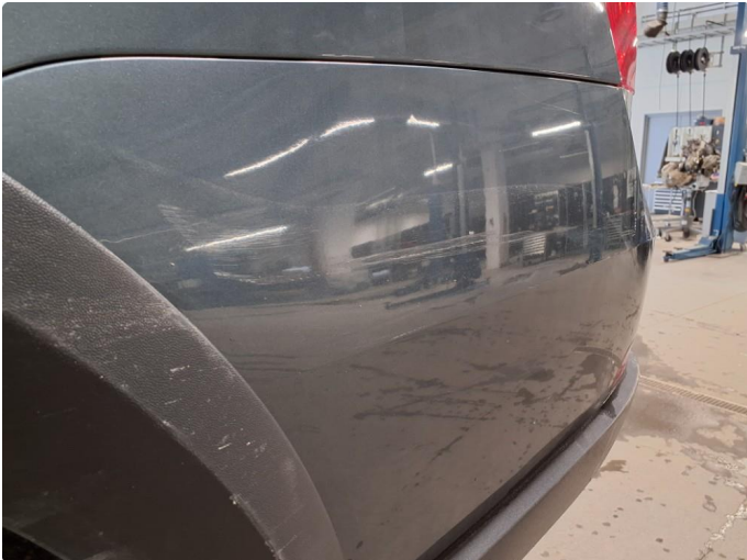
1.3 Ripe(r) ned til grunning
