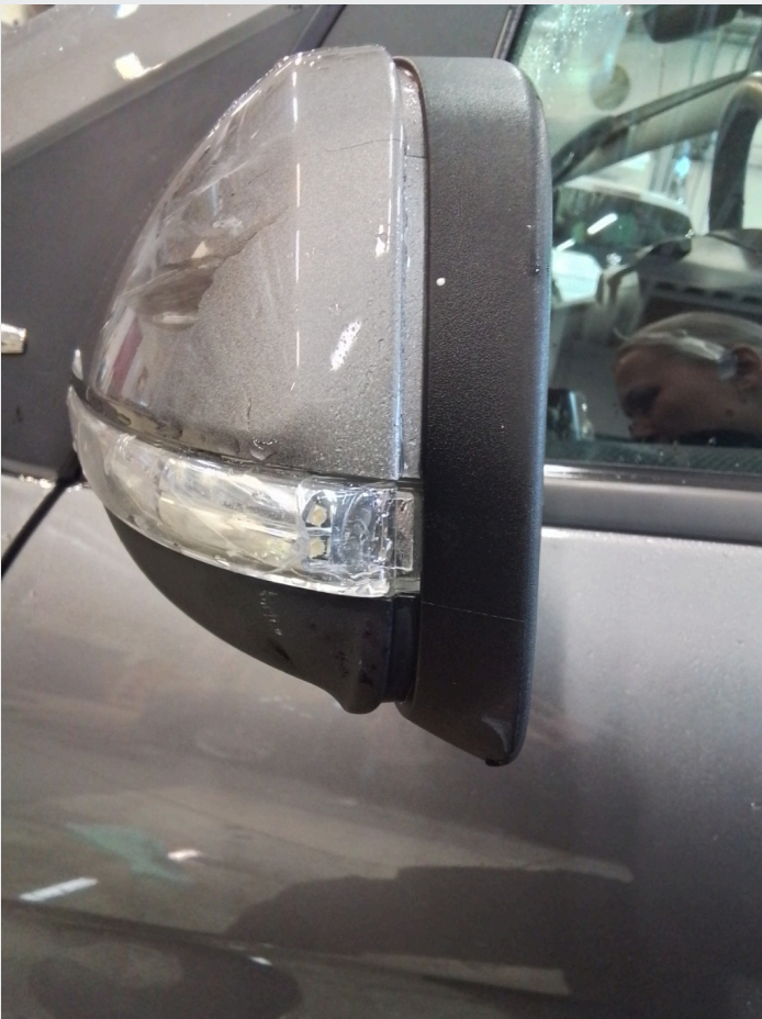
3.4 Sprekk i bliklysglass på venstre speil
