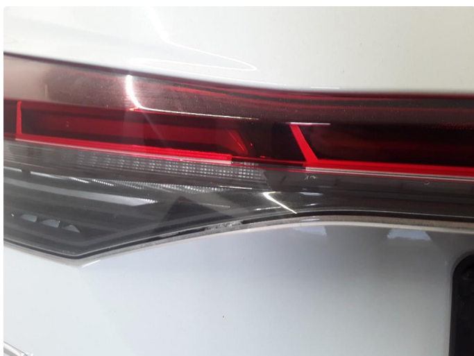
3.2 Krakelering i plast
