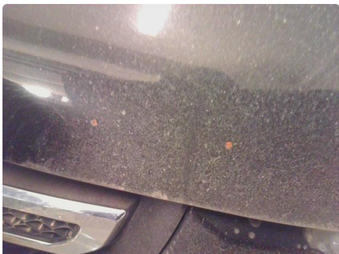
1.2 Noe steinsprut med rust
