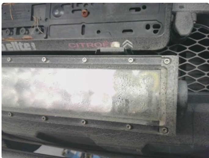
2.1 Ekstra fjernlys skadet
