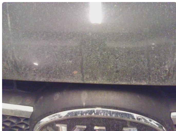
1.2 Noe steinsprut med rust
