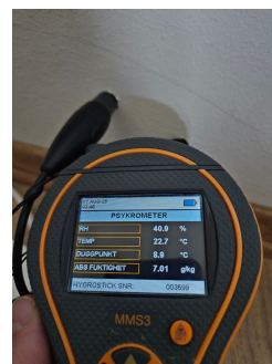
Måling av relativ luftfuktighet i lukket veggkonstruksjon mellom bod og dusjsone.
