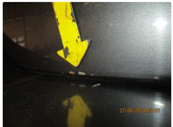
2.2 Rust/korrosjon nedre del bakluke
