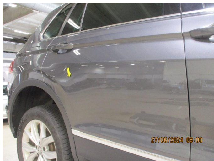
2.6 Flere p-bulker rundt om. H.fordør + H.bakdør + H.forskjerm + v.fordør + v.bakskjerm.
