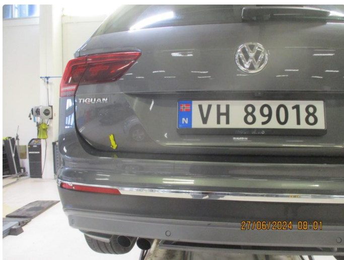
2.2 Rust/korrosjon nedre del bakluke
