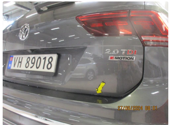
2.2 Rust/korrosjon nedre del bakluke
