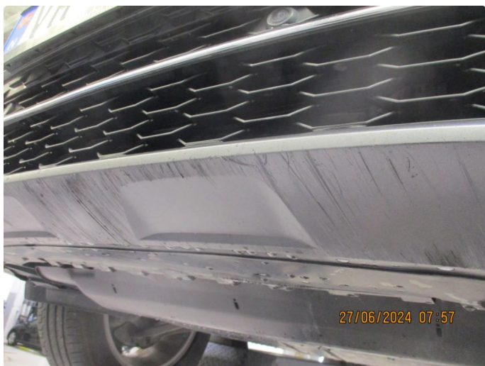
2.5 En del riper undersiden fanger foran + fanger bak.
