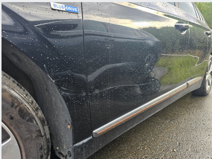
2.5 Stripe langs førerdør, blir bedre med polering
