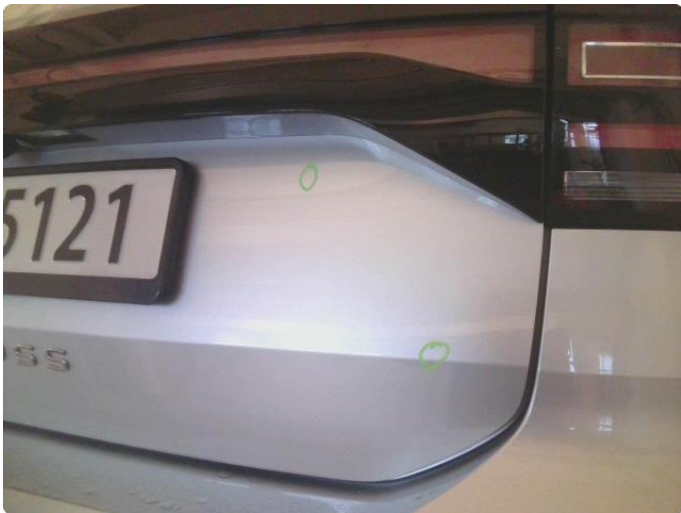
1.1 Steinsprut med rust
