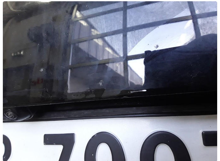
1.3 Steinsprut med korrosjon.
