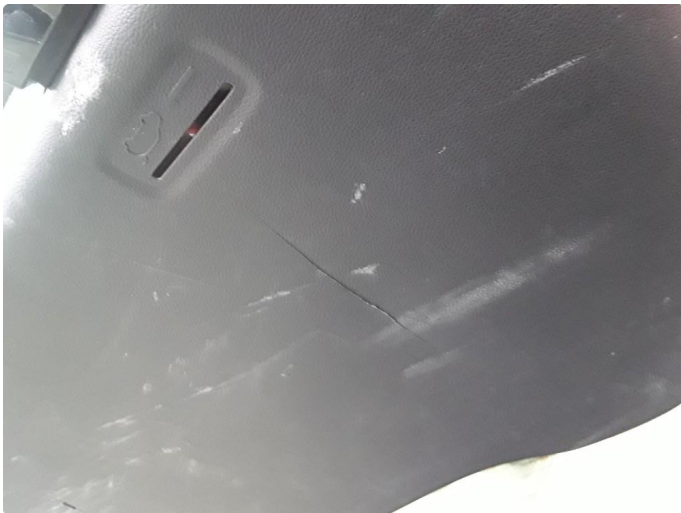
1.2 Noe skadet deksel på bakluke.
