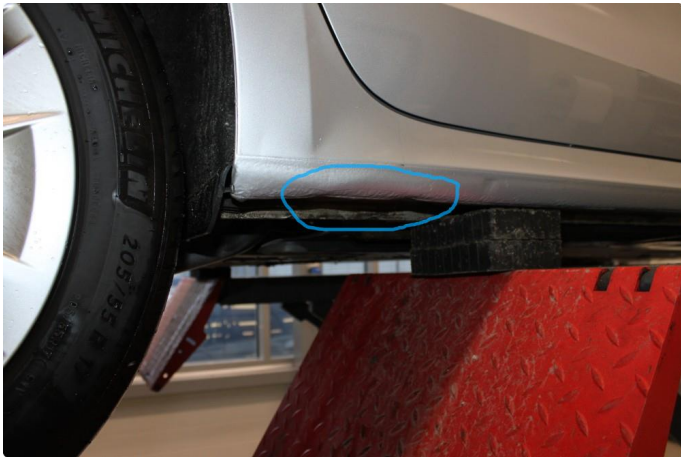
1.2 Liten skade i kanal, ser ut som om det er forsøkt jekket.
