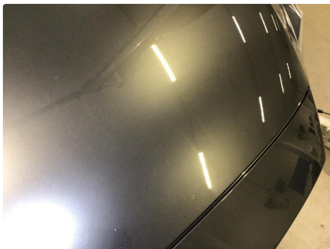
1.2 Noe steinsprut på panser er utbedret med smart repair
