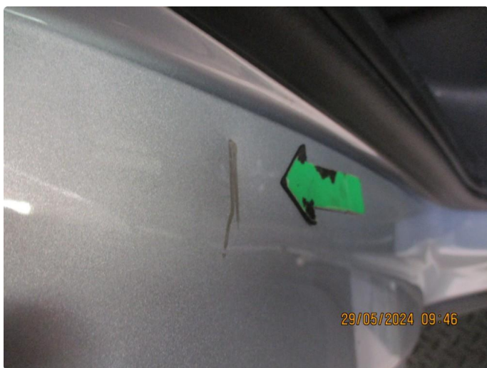
1.5 Bulk(er) med lakkskade, innsteg h.bakdør
