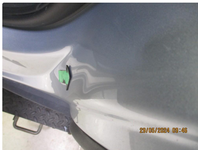
1.4 Bulk innsteg v.bakdør
