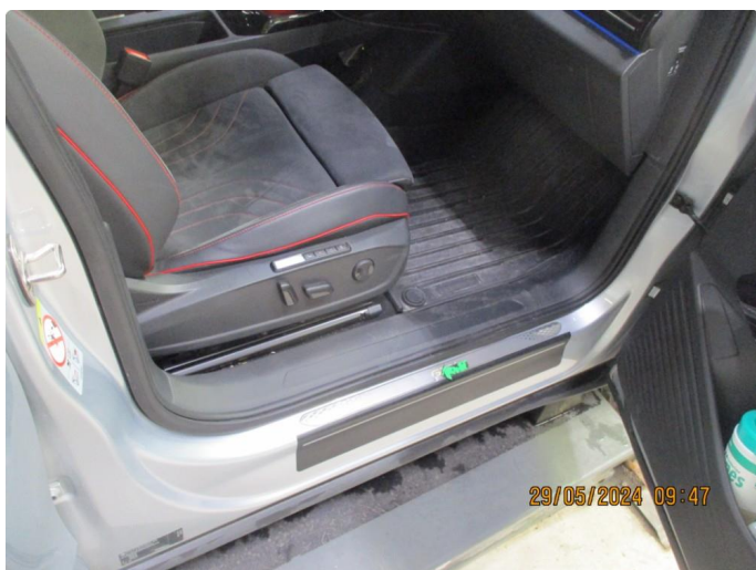
1.6 Skade list innsteg h.fordør
