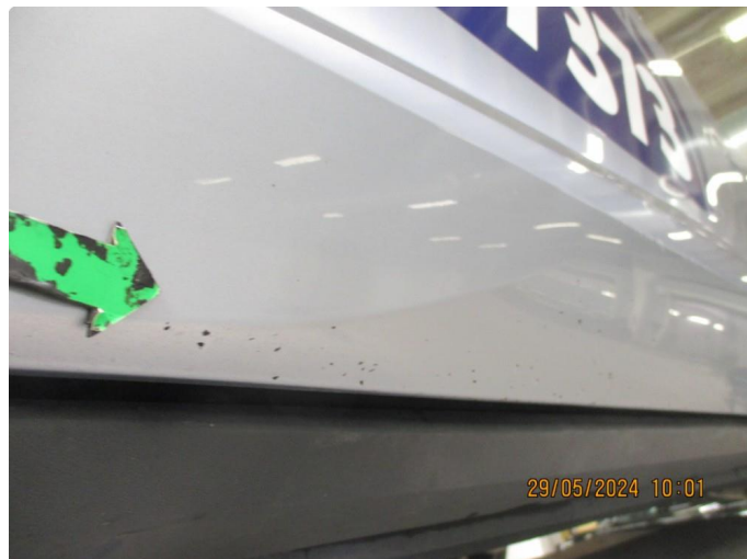
1.1 En god del steinsprut på dører
