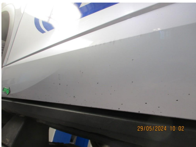
1.1 En god del steinsprut på dører
