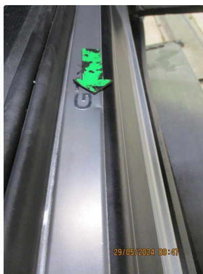
1.6 Skade list innsteg h.fordør
