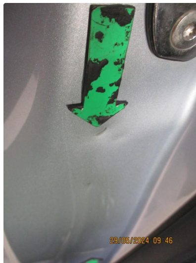
1.5 Bulk(er) med lakkskade, innsteg h.bakdør
