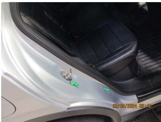
1.5 Bulk(er) med lakkskade, innsteg h.bakdør
