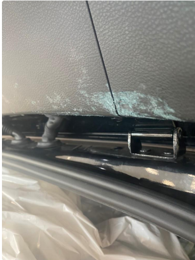
2.1 Innvendig deksel/kledning bakluke skadet i plastikk
