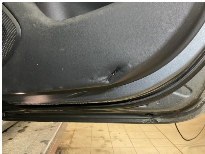
2.2 Skader på dørtrekk høyre side bak. Blir reparert med smartrepar
