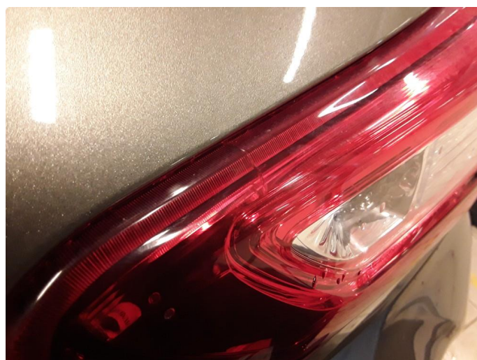
2.1 Noen sprekker i glass venstre og høyre indre lampe.
