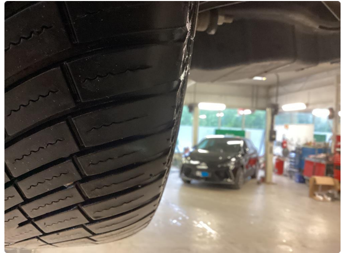
1.2 Skjev slitasje på sommerdekk
