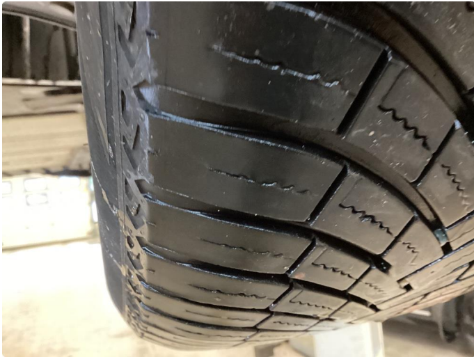
1.2 Skjev slitasje på sommerdekk
