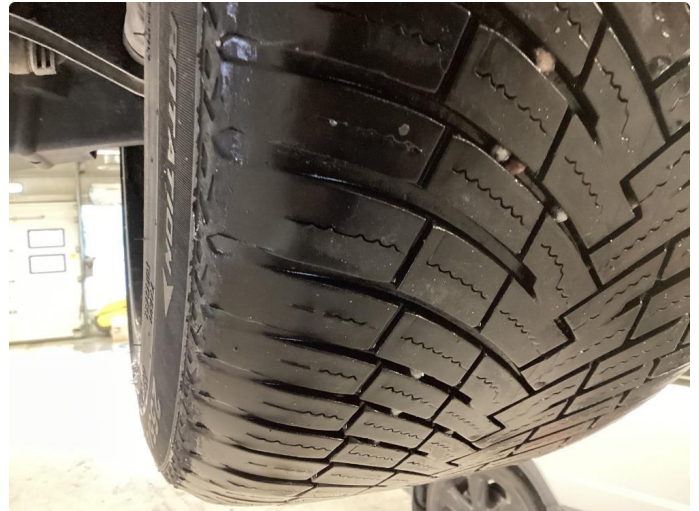
1.2 Skjev slitasje på sommerdekk
