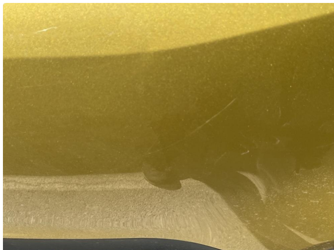
1.1 Liten bulk i dør Åpning VF Liten ripe i Dør HF
