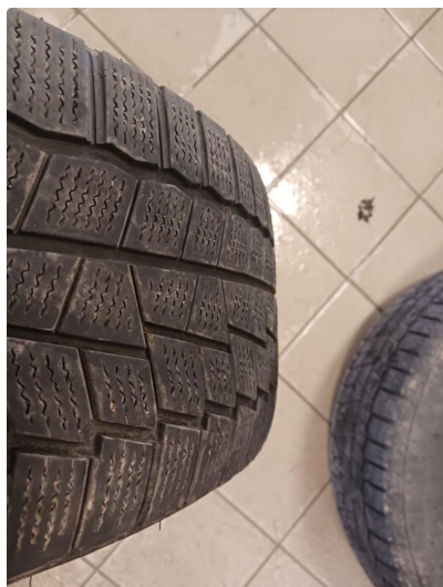
1.1 Skjev slitasje på vinterdekk
