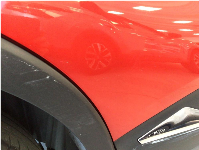
1.1 Litt overfladiske riper på bakdører, dette blir å anse som normal bruksslitasje
