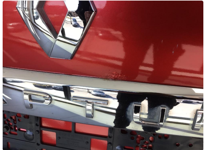
1.2 Liten korrosjons-flekk på bakluke ved emblem
