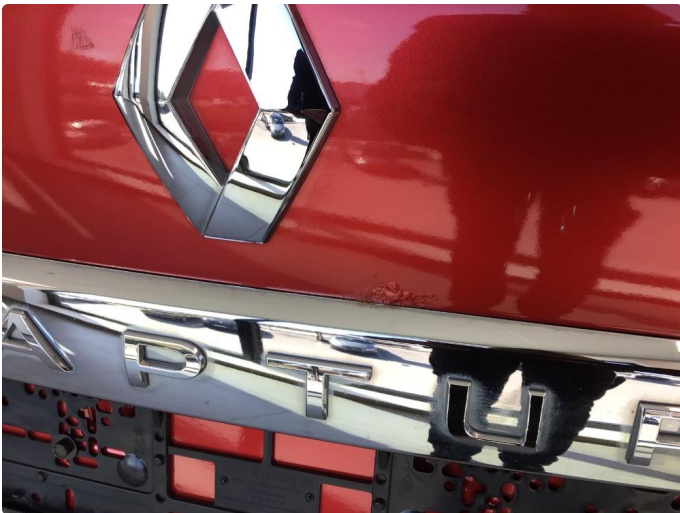
1.2 Liten korrosjons-flekk på bakluke ved emblem
