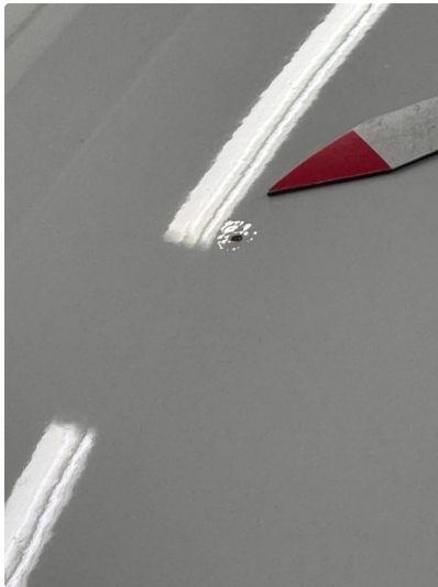
1.3 Steinsprut med korrosjon.
