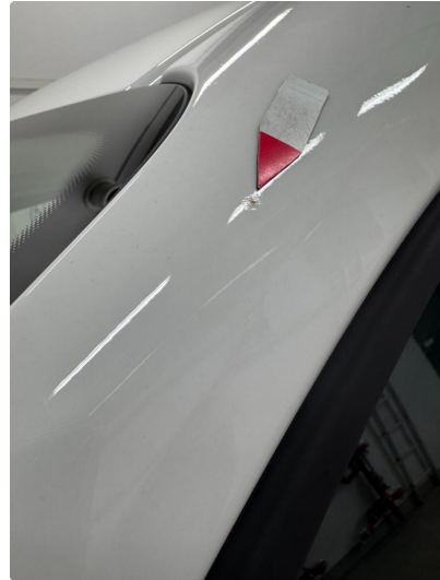
1.3 Steinsprut med korrosjon.
