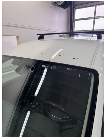
1.3 Steinsprut med korrosjon.
