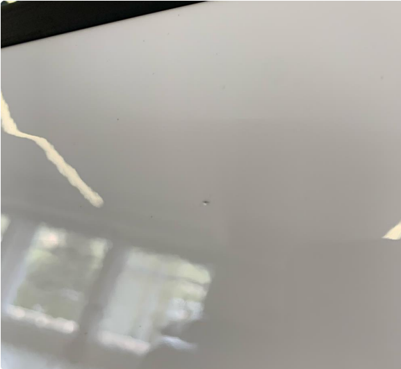
1.2 Liten steinsprut med korrosjon venstre fordør.
