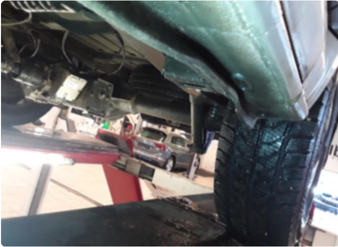
1.1 Noen småbulker / lakkriper / steinsprut. Noe bøyd jekkfester vestre og høyre bak.
