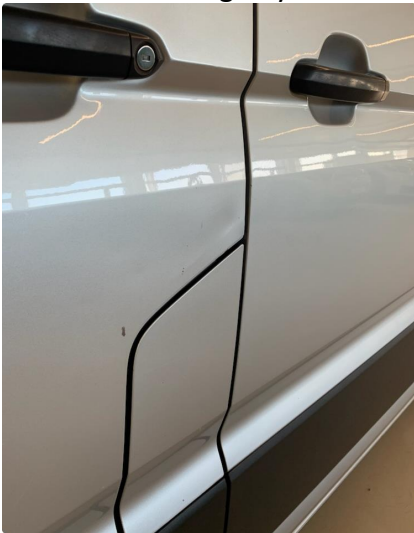
1.1 Noen småbulker / lakkriper / steinsprut. Noe bøyd jekkfester vestre og høyre bak.
