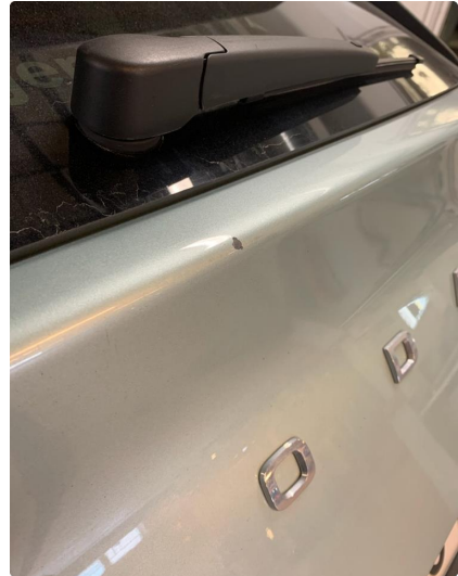
1.2 Noe riper og lakksår.
