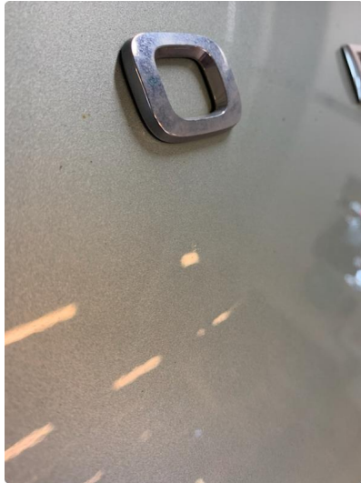
1.2 Noe riper og lakksår.
