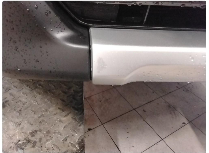
1.2 Steinsprut på plast del av støtfanger fremme, flikket i.
