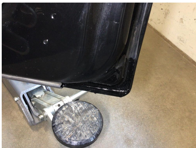
2.3 Noe overfladisk korrosjon i dører
