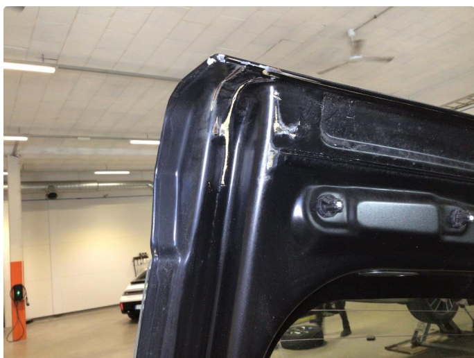
2.3 Noe overfladisk korrosjon i dører
