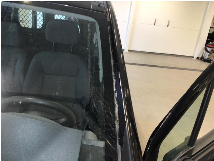
2.5 Korrosjon langs A-stolpe begge sider er utbedret tidligere
