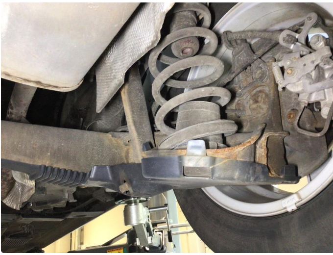
5.1 Overflaterust i bakstilling, ingen tiltak kreves
