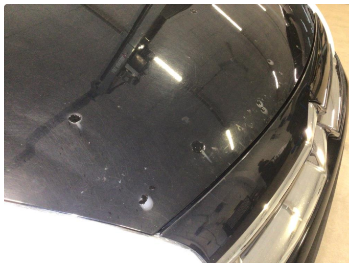
2.2 Korrosjon i fals på panser er utbedret tidligere
