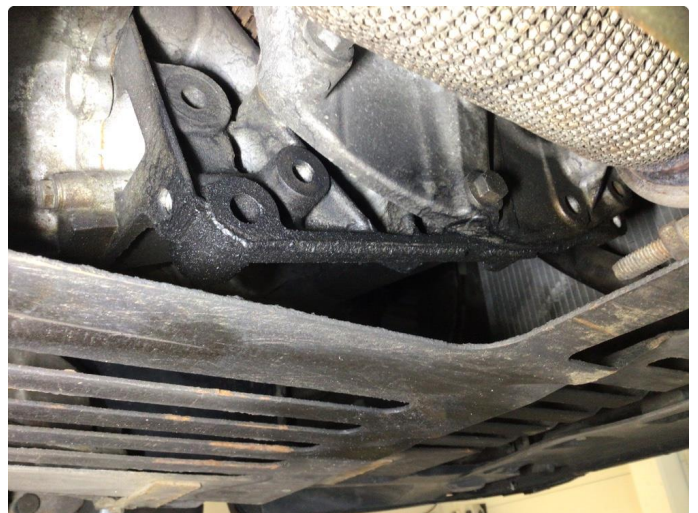
4.1 Litt ubetydelig oljesvetting mellom motor og gear
