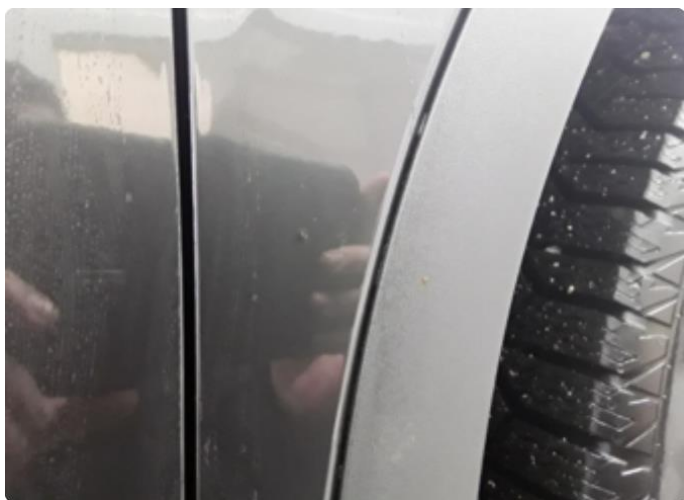
1.4 Liten steinsprut med korrosjon høyre forskjerm.
