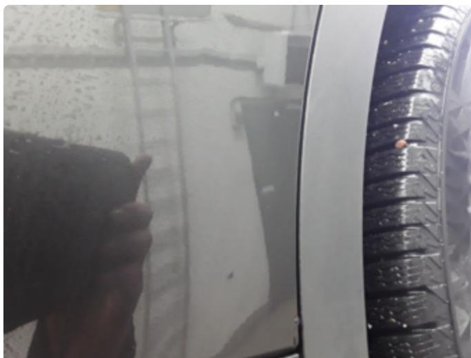
1.2 Liten steinsprut med korrosjon venstre bakhjør.
