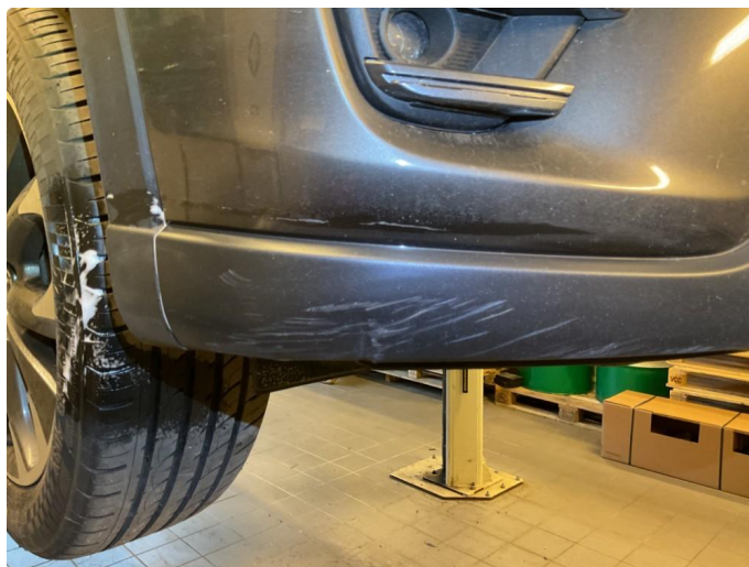
1.6 Noe riper i plastikkdeksel høyre foran. Fremstår ikke sjenerende
