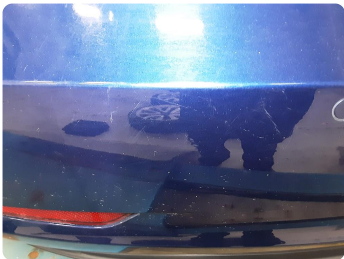
3.12 Ripe(r) ned til grunning
