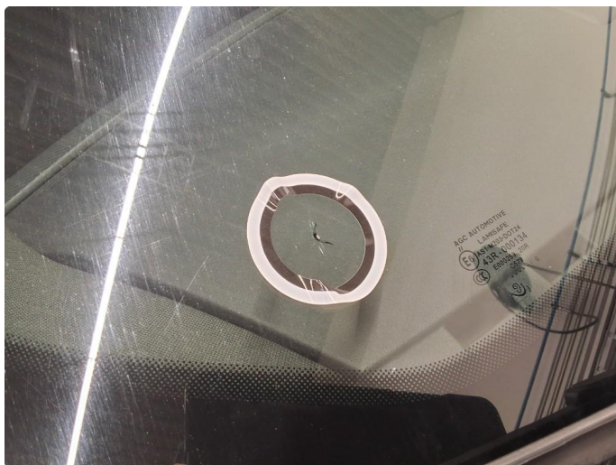
1.9 Steinsprut med sprekk utenfor synsfelt
