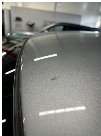
1.5 Steinsprut. Rep med lakk
