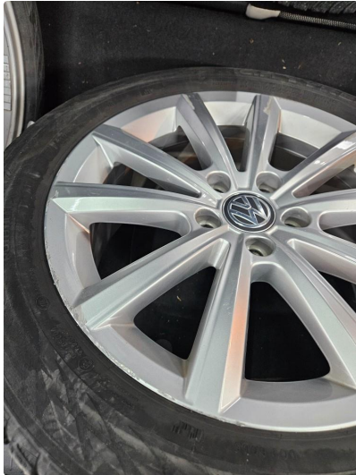
1.3 Riper/skrubbemerker på en alu. vinterfelg
