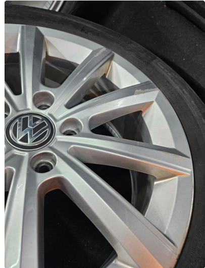
1.3 Riper/skrubbemerker på en alu. vinterfelg
