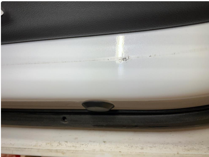
1.2 Høyre fordør - korrosjon innvendig nedre del
