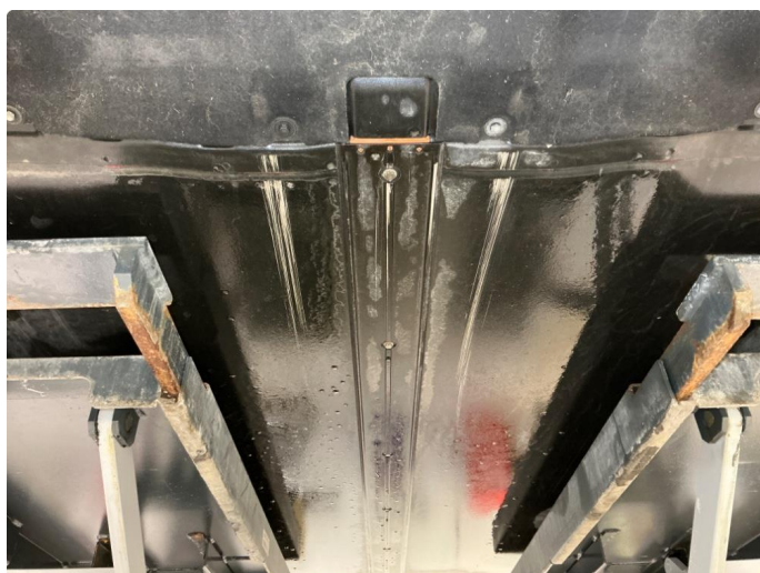
3.1 Ripper / skrape i plate under batteri - ok
