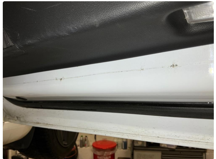
1.2 Høyre fordør - korrosjon innvendig nedre del
