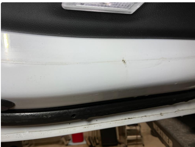
1.3 Venstre for og bakdør - korrosjon innvendig nedre del
