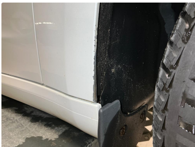
1.7 Høyre forskjerm -lakk flasser
