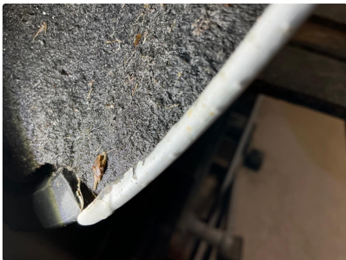
1.5 Høyre bakskjerm -lakk flasser
