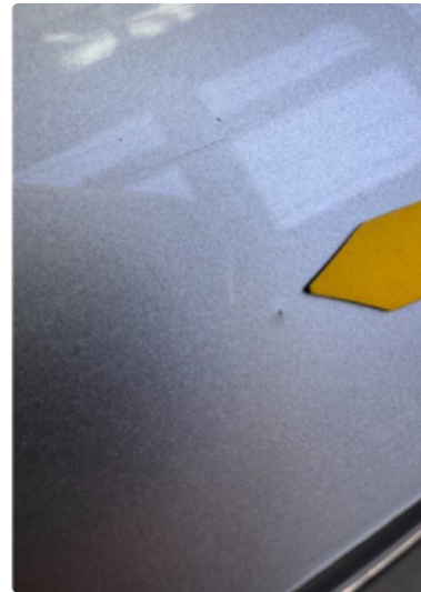
1.3 Liten steinsprut med korrosjon bakluke.
