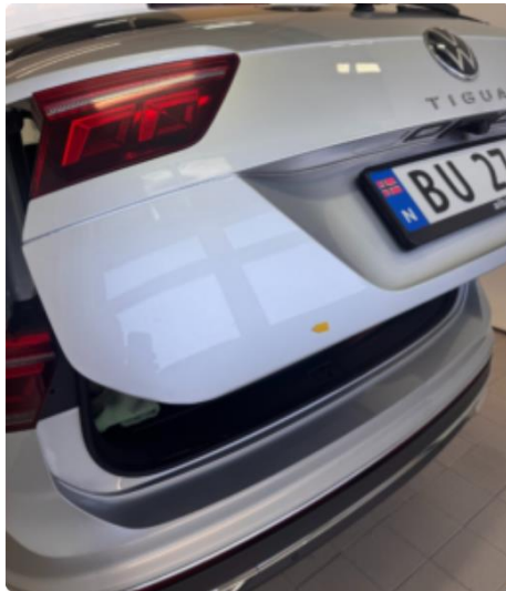
1.3 Liten steinsprut med korrosjon bakluke.
