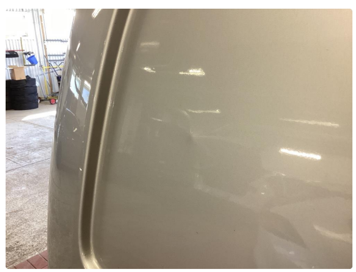
1.1 Noe riper og steinsprut og litt slukt etter alder
