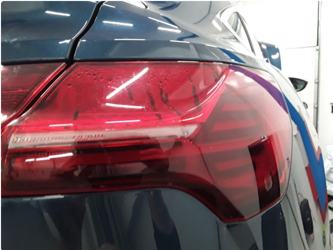
2.1 Oppdaget dugg/fukt i høyre baklykt. Garanti. Time bestilt
