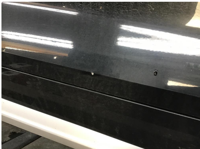
1.1 Noe korrosjon på dører
